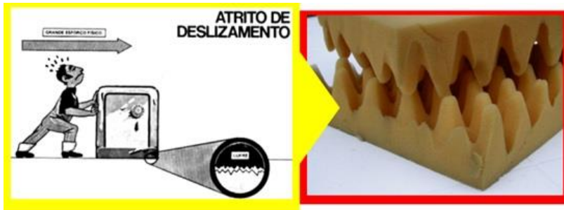
Figura 7 – Conjunto de Figuras 6: figura ilustrativa do atrito de deslizamento (esquerda) e imagem ilustrativa ampliando o detalhe da figura a esquerda (direita). Disponível em: http://jt-commodities.blogspot.com/2012/08/oferta-minerio-de-titanio-quantidade.html . Acesso em: 16 nov. 2017 (esquerda). Disponível em: https://engenhariadesuperficies.files.wordpress.com/2014/04/imagem-abril.jpg . Acesso em: 16 nov. 2017 (direita).
