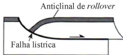
Figura 2.3 - Seção esquemática em perfil da disposição do anticlinal de rollover sobre uma falha lítrica (modificado de Pluijm & Marshak, 2004).
