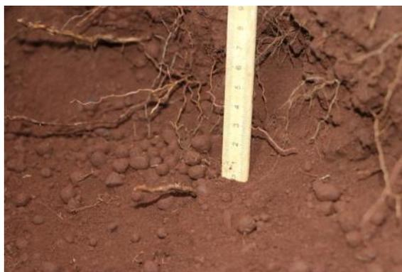
**Figura 4.5** – Detalhe nas concreções em forma de chumbo de caça, em GDR-1.
