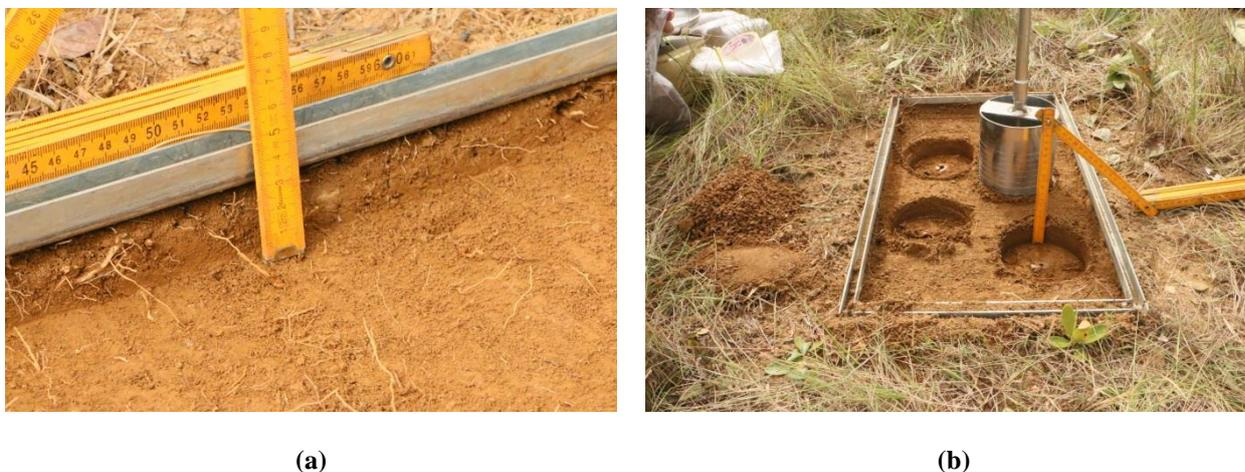
**Figura 3.6** – a) Finalização da coleta com o prato raspador; b) amostragem em incrementos de profundidade com o trado de Andrello após a utilização do prato raspador.
