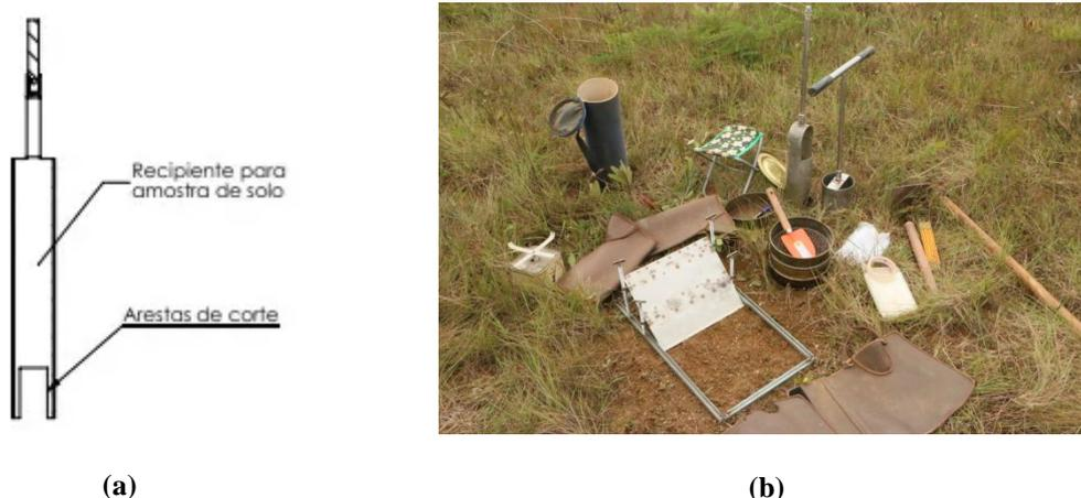
Figura 3.7 – (a) Esquema do trado caneco utilizado; (b) material utilizado em campo, incluindo o trado caneco.
