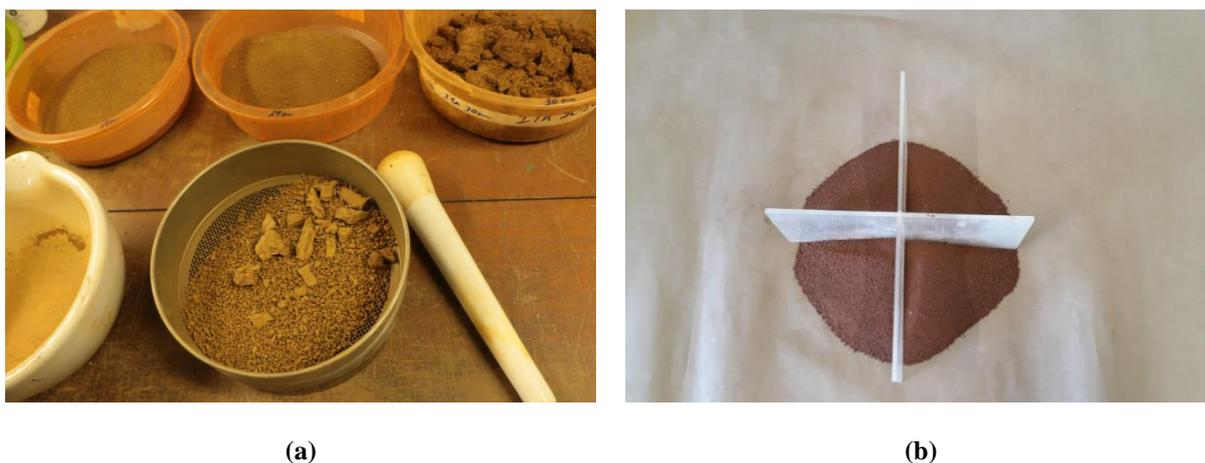
**Figura 3.9** – (a) Destorroamento das amostras; b) quarteamento das amostras.
