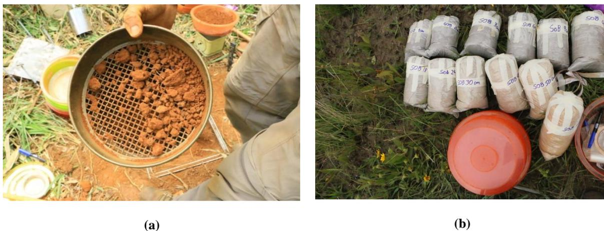
Figura 3.8 – (a) Peneiramento em campo; (b) conjunto de amostras identificadas após a coleta.
