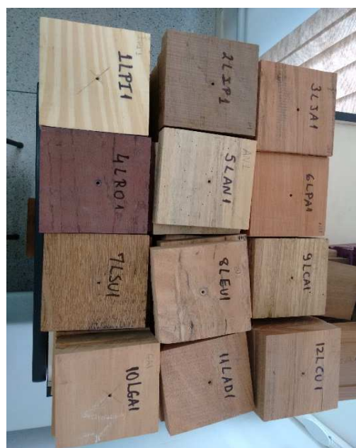
Figura 3.3: Preparação dos corpos de prova para ensaio no CCPM.
