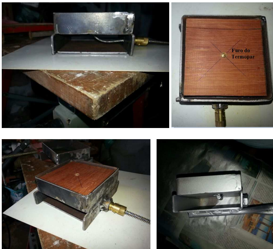
Figura 3.1: Suporte para uso no CCPM com a perfuração para o termopar.
