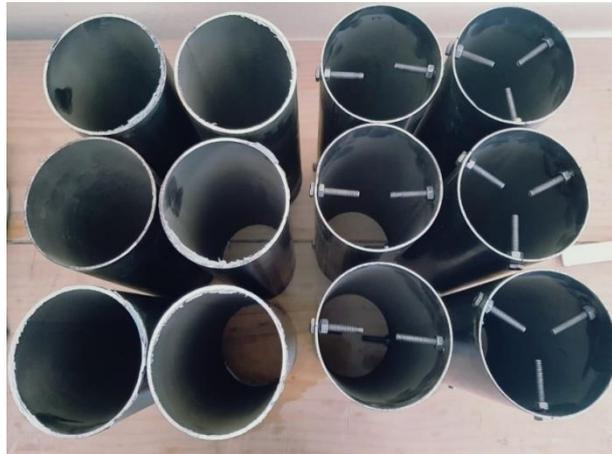
Figura 3.5 – Corpos de Prova Grupo TUBO, SCON, 4CON e 6CON.
