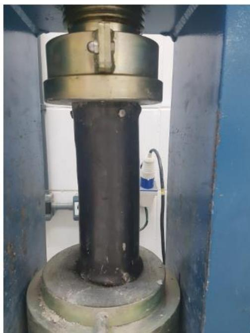
Figura 5.7 – Ensaio compressão corpo de prova grupo 6CON
