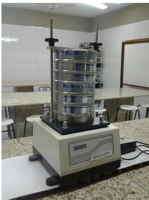
Figura 7.1 – Agitador mecânico agregado miúdo.
