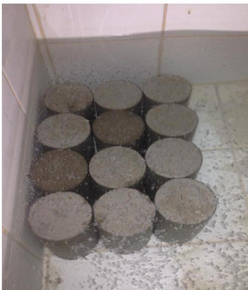
Figura 3.3 – Tanque de cura.
