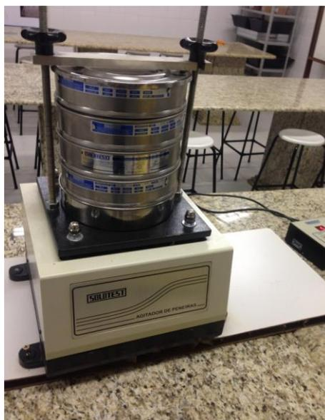
Figura 7.2 – Agitador mecânico agregado graúdo.
