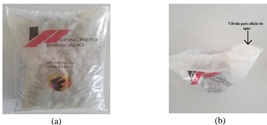
Figura 3.2 – Concreto ensacado com embalagem reduzida de amostra (2 kg), (a) na posição horizontal, com válvula de adição de água fechada; (b) na posição vertical, demonstrando a válvula de adição de água aberta.
