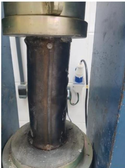
Figura 5.5 – Ensaio compressão corpo de prova grupo 4CON
