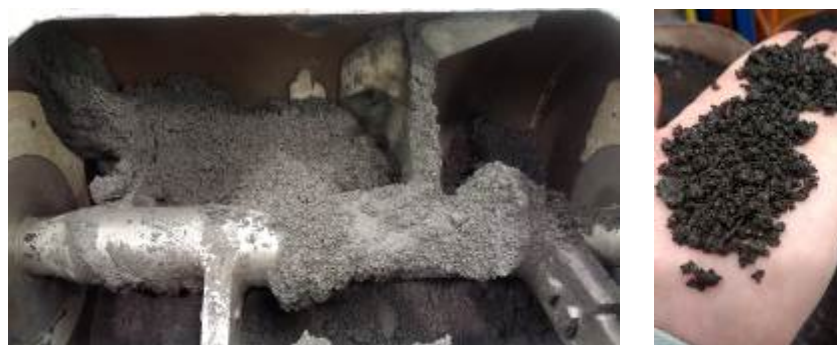
Figura 5.10: Aspecto do material preparado pela rota ALT após etapa de nodulização.
