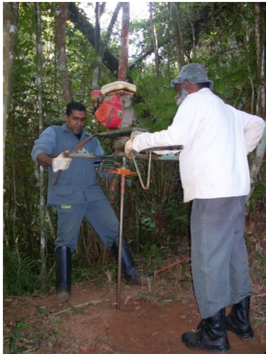
Figura 3.2 - Tradagens realizadas para a obtenção dos perfis de sondagem.
