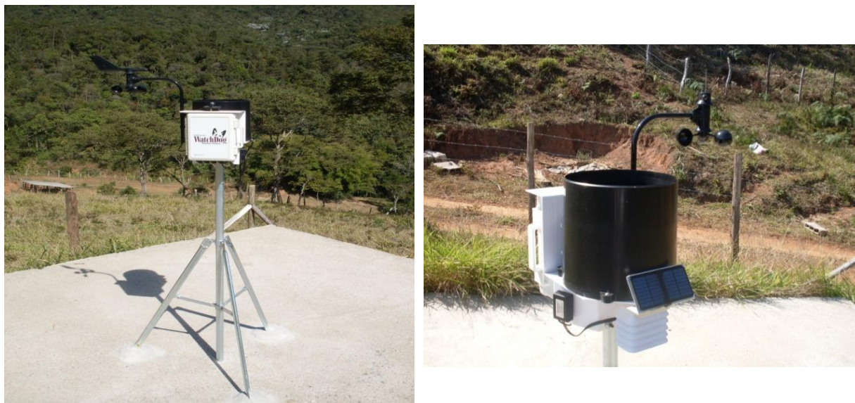
Figura 3.4 - Estação meteorológica Tracom-Watchdog 2900ET instalada na Fazenda Brígida (à esquerda) e detalhe do recipiente coletor (à direita).
