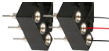
Figura 3 : Imagem de um conector soquete torneado de 3 pinos DIP conectado aos fios de cobre, Fio 1, fio 2 (terra), fio 3. O posicionamento dos fios está descrito detalhadamente no item 4.7.
