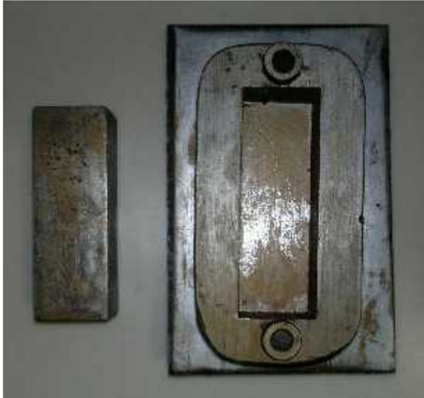
Figura 5.2: Molde utilizado para a confecção dos corpos cerâmicos.
