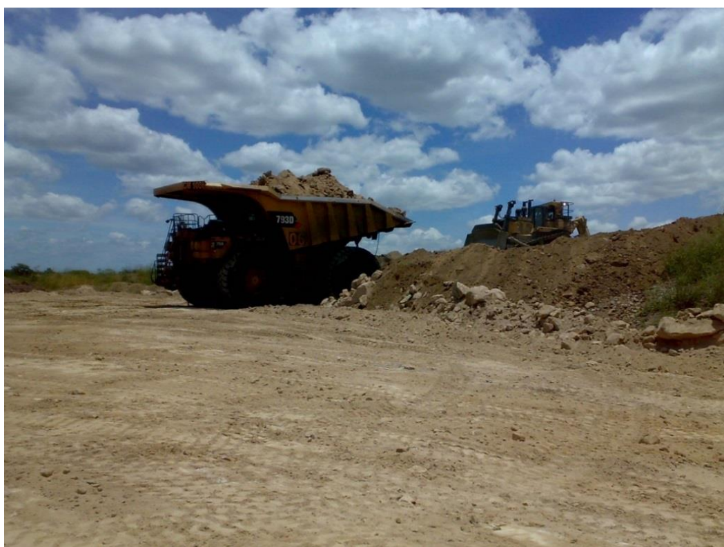
Figura 7. Caminhão depositando estéril na PDE.
