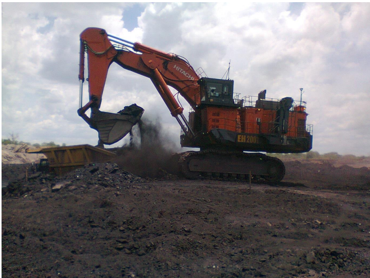
Figura 4. Desmante mecânico de estéril por meio de uma retro-escavadeira hidráulica.
