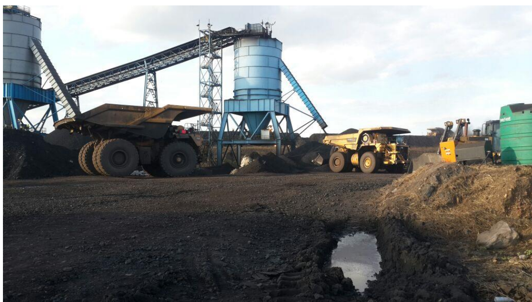
Figura 5. Caminhão aguardando carregamento no silo de rejeito.
