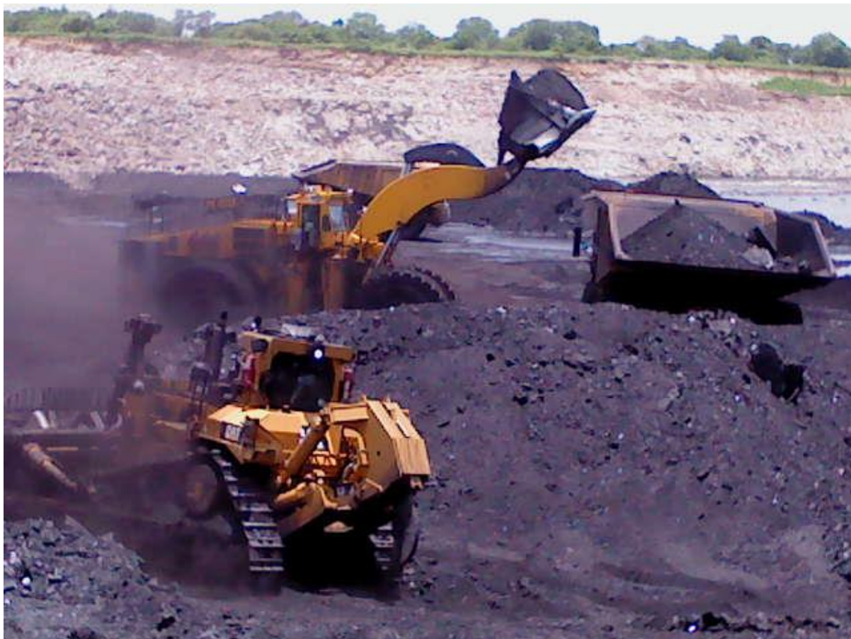
Figura 3. Desmonte mecânico da camada de carvão com espessura de aproximadamente 90 cm.
