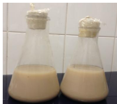
Figura 9: Processo de lise osmótica das leveduras residuais para obtenção do extrato
