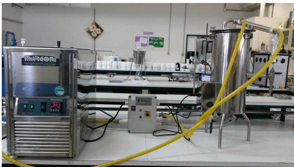
Figura 48 – Foto do Hidrodestilador (Linax), usado na extração do óleo essencial.
