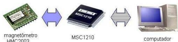
Figura 6: Esquema da conexão dos componentes da montagem para determinação de atitude utilizando o módulo MSC1210.
