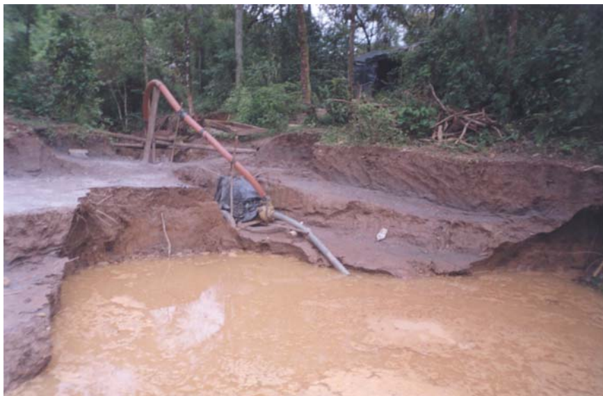
Figura 7 - Vista de uma frente de garimpo de leito com draga no Alto Cipó. A foto mostra o lado onde é feita a escavação do material.
