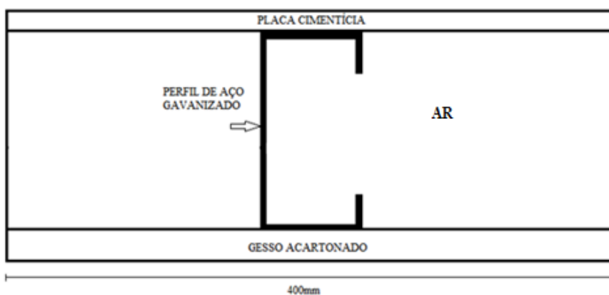
Figura C.1- Esquema da célula do fechamento em Light Steel Framing com cavidade preenchida com ar
