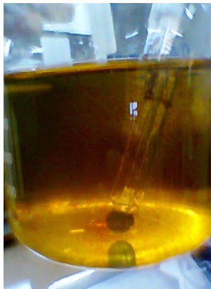
Figura 32: Coloração da dispersão contendo 0,1% p/p de rodonita, condicionada com 10^{-3} M de MnCl_2 , no pH 10.
