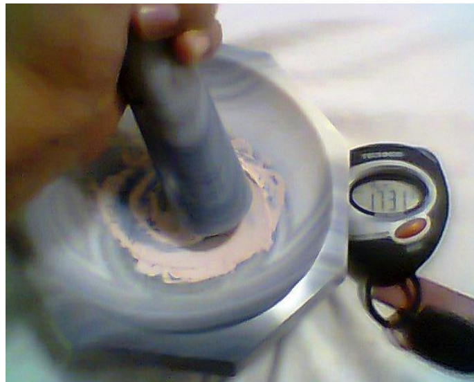
Figura 13: Pulverização da rodonita em grau de ágata para determinação de potencial zeta.
