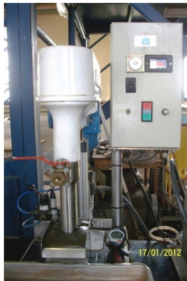
Figura 16: Célula de flotação de bancada, utilizada nos ensaios de flotação dos finos do minério sílico-carbonatado de manganês de Morro da Mina.
