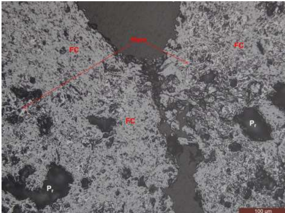
Figura 6.43 – Fotomicrografia de amostra de sínter STG3. Nota: microscopia ótica com luz refletida (nicóis paralelos). Legenda: Hem – hematita; FC – ferritos de cálcio (ou calcioferritas); P r – poros.
