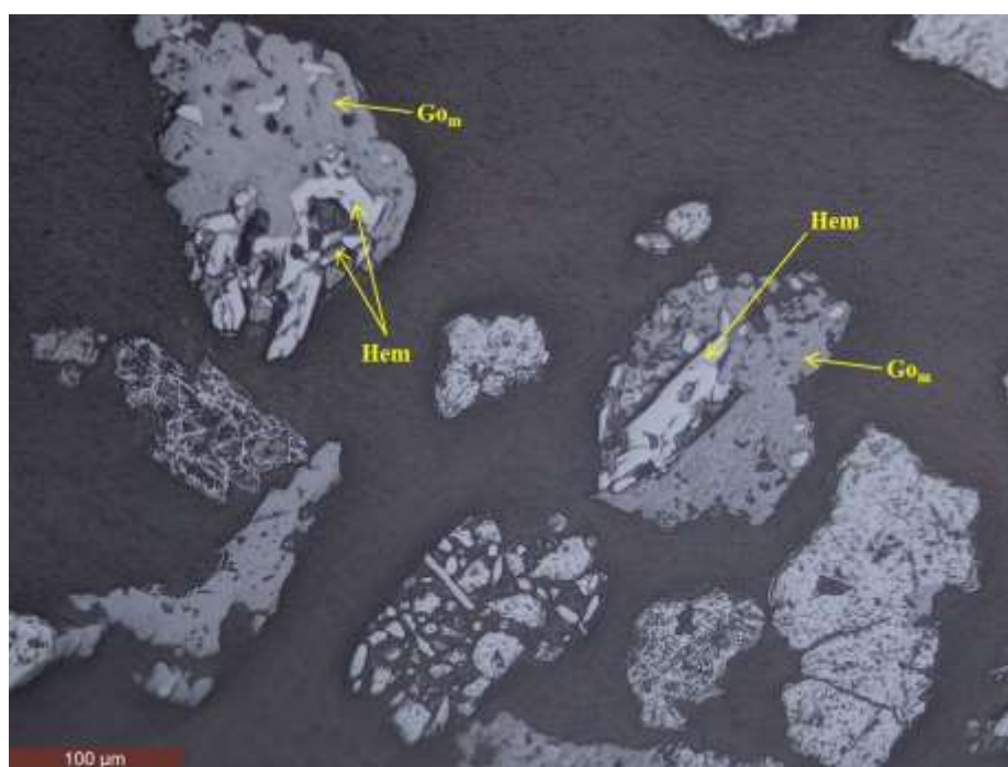
Figura 6.14 – Fotomicrografia da faixa granulométrica -0,15mm +0,105mm da amostra de minério de ferro goethítico. Nota: microscopia ótica com luz refletida (nicóis paralelos). Legenda: Hem – hematita, Go m – goethita massiva.
