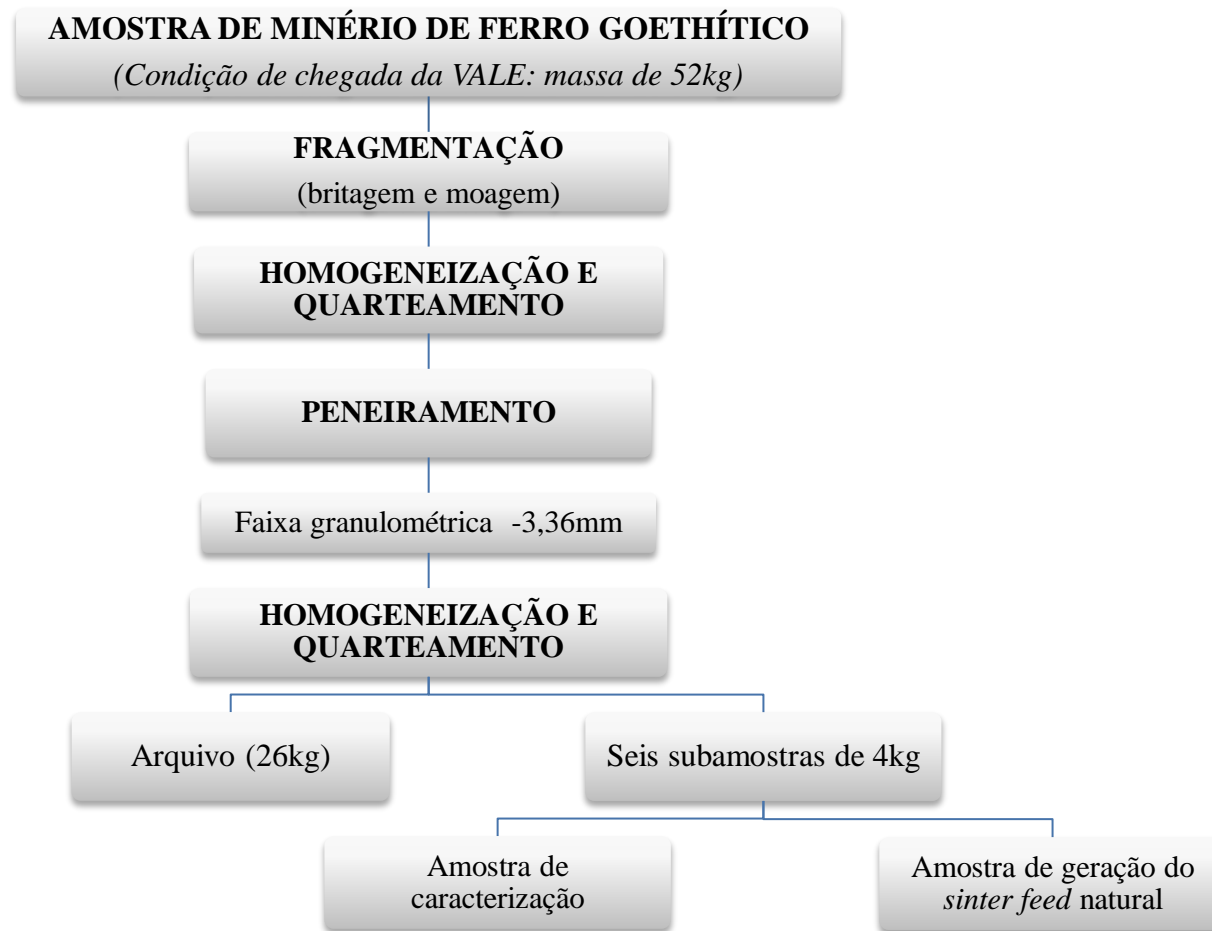
Figura 5.1 – Fluxograma de preparação da amostra de minério de ferro goethítico usado presente estudo.
