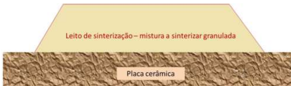
Figura 5.6 – Corte transversal esquemático da disposição da mistura a sinterizar granulada sobre a placa cerâmica.
