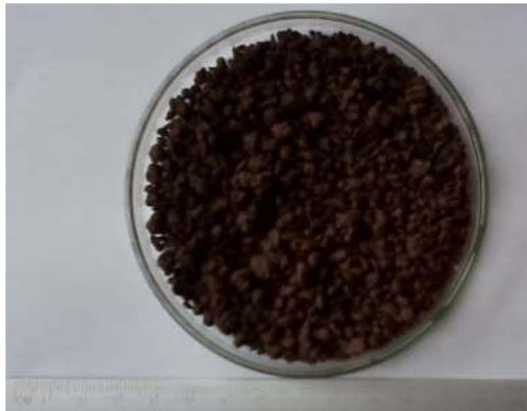
Figura 6.36 – Aspecto visual da mistura a sinterizar granulada com amostra calcinada de sinter feed G1.
