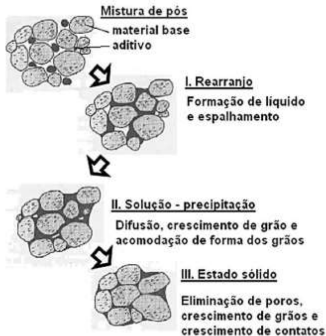
Figura 4.2 – Representação esquemática dos estágios desenvolvidos ao longo da sinterização em fase líquida (Torres, 2009).
