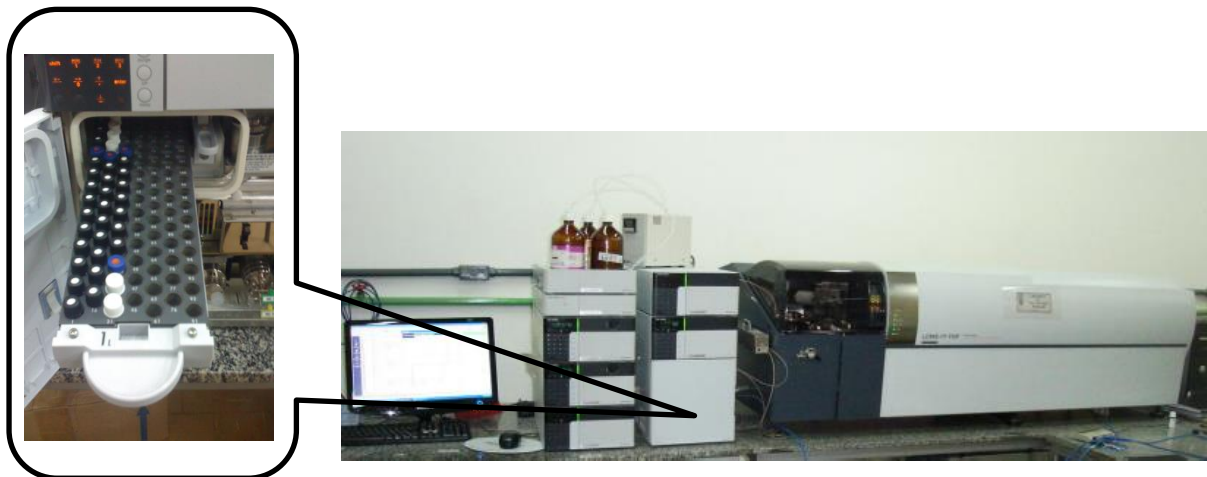
Figura 4.7 - Equipamento de cromatografia líquida de alta eficiência acoplada à espectrometria de massas ( HPLC-MS ), com detalhe no compartimento de porta-amostras.
