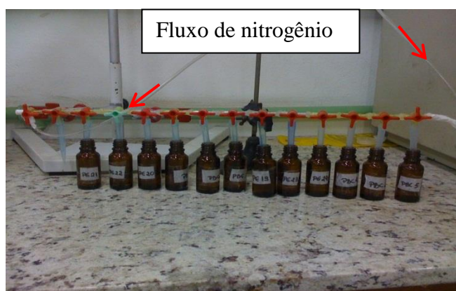
Figura 4.6 - Processo de secagem de várias amostras utilizando nitrogênio gasoso.
