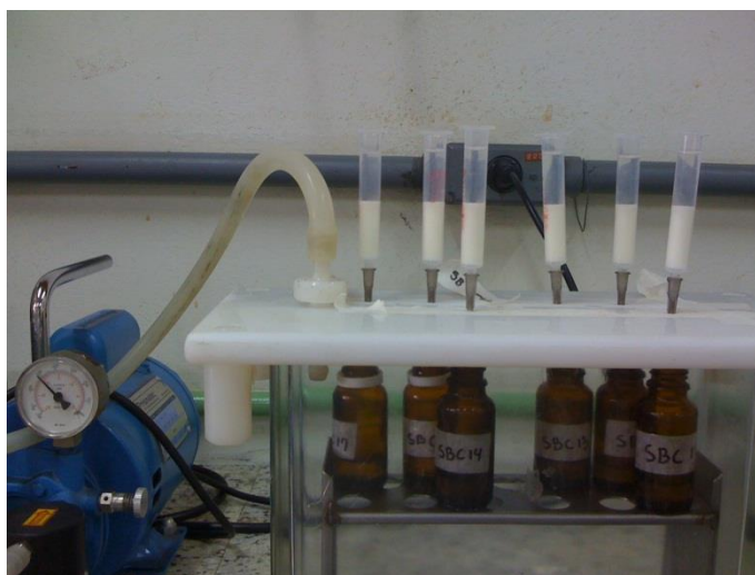
Figura 4.5 - Processo de eluição dos cartuchos de extração.
