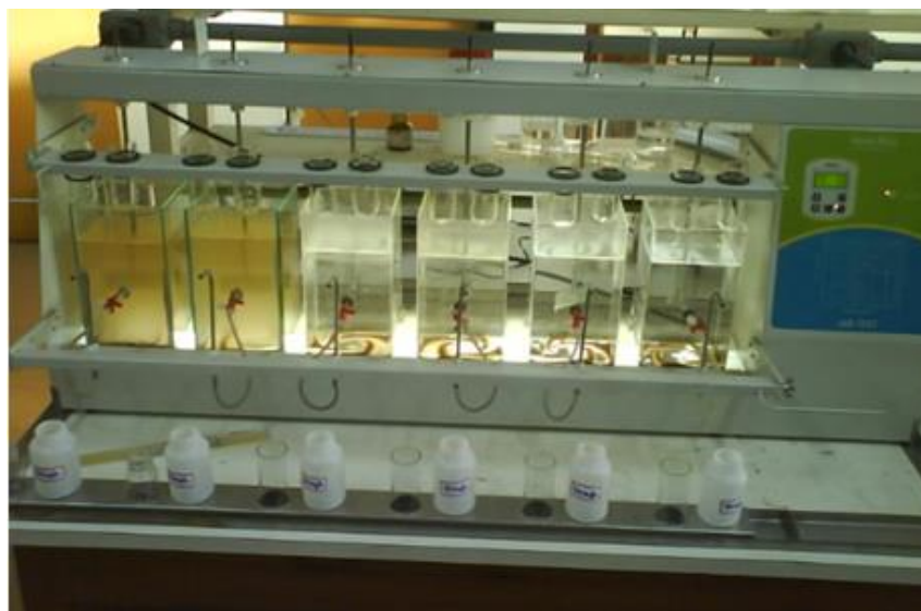
Figura 4.0 - Equipamento Jarrest utilizado para simular o tratamento por clarificação.
