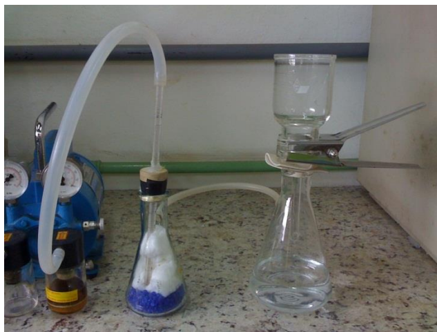
Figura 4.2 - Procedimento de filtragem das amostras (água bruta e água tratada).
