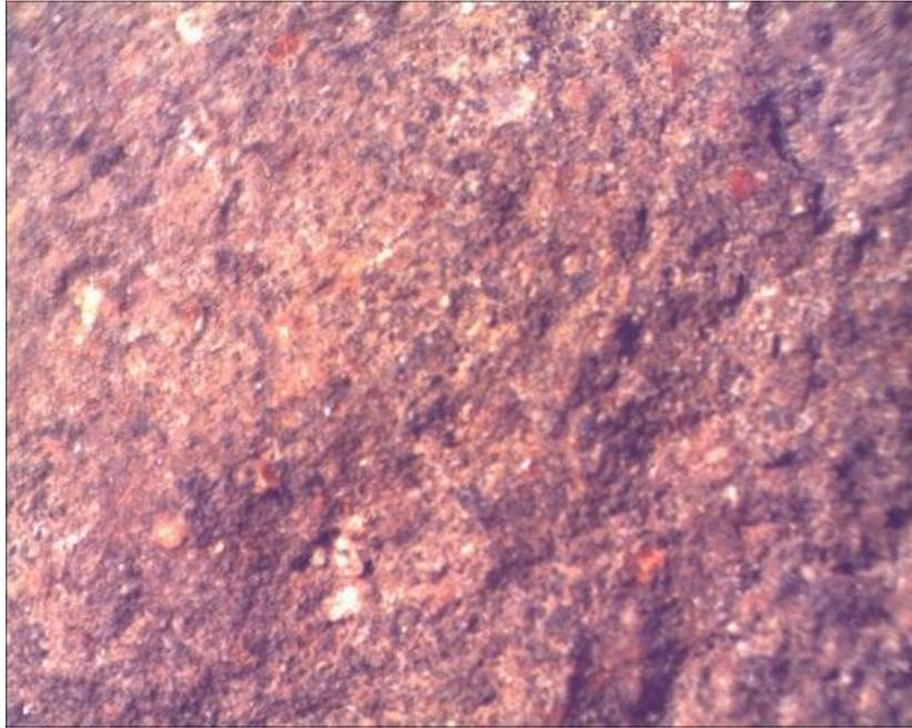
Figura 4.20 - Superfície fraturada de um corpo de prova do concreto
