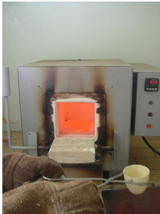
Figura 3.1 –Materiais utilizados no ensaio de perda ao fogo.
