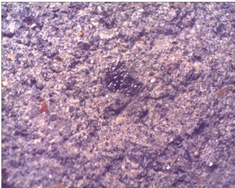
Figura 4.21 - Superfície fraturada de um corpo de prova do concreto
