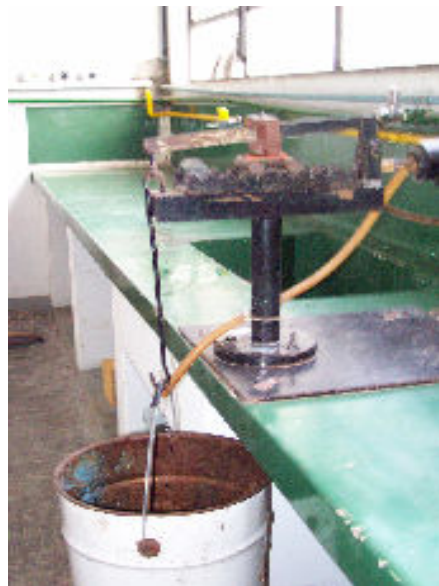
Figura 3-3 - Dispositivo para realização do ensaio para determinação da TRF.
