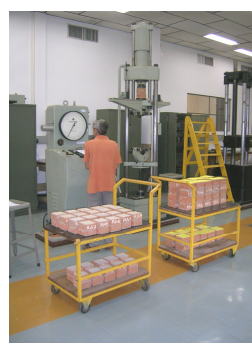
Figura 4.25 - (A) Corpo de prova colocado na prensa para ensaio de compressão; (B) Realização dos ensaios de compressão
