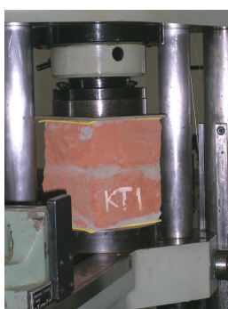
Figura 4.25 - (A) Corpo de prova colocado na prensa para ensaio de compressão; (B) Realização dos ensaios de compressão
