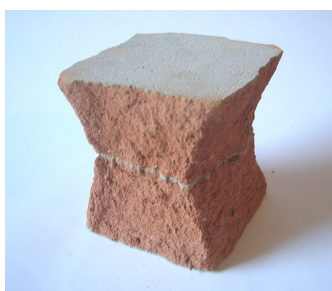
Figura 5.9 – Corpo-de-prova rompido - formato típico: taça Fonte: Autor
