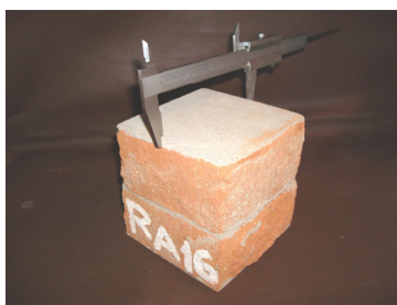
Figura 4.23 – Corpos-de-prova capeados e retificados
