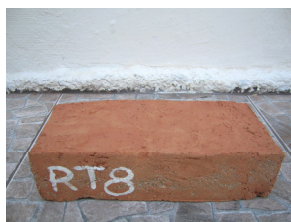
Figura 4.20 – Marcação dos adobes
