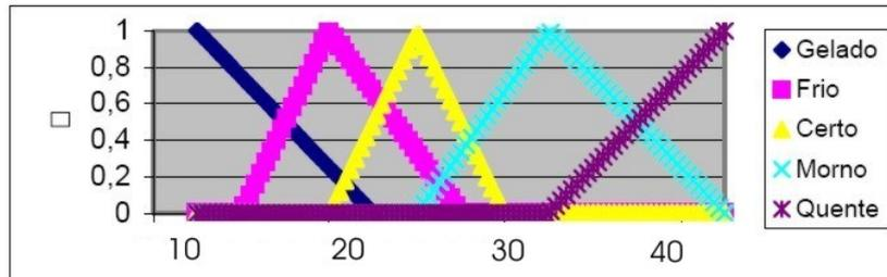
Figura 2.5 – Gradação das temperaturas segundo a critérios difusos
