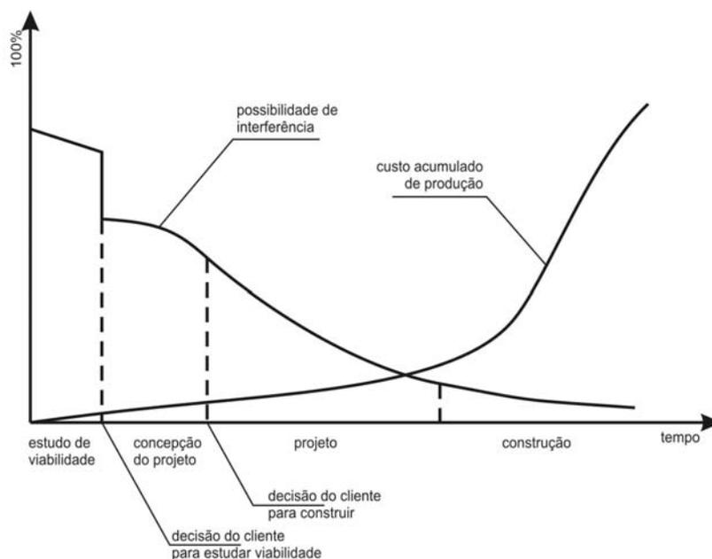
Figura 1.1 – Possibilidade de intervenção e custos acumulados ao longo da produção de um empreendimento de construção.
