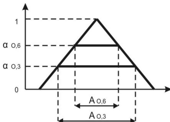
Figura 2.20 – Conjuntos de Corte –  $\alpha$  para:
