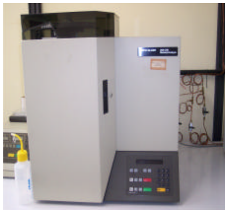
Figura 4.33 – Fotografia do equipamento utilizado para análise elementar, modelo PE 2400II CHN Analyzer, do departamento de química da UFMG.
