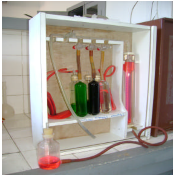
Figura 4.42 - Vista geral do analisador de gás ORSAT.
