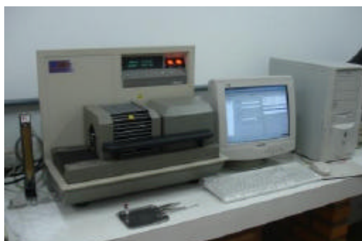
Figura 4.37 – Representação fotográfica do equipamento de ensaio termogravimétrico, modelo SDT 2960, no DEQUI da UFOP
