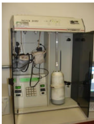
Figura 4.34 – Fotografia do equipamento utilizado para análise de porosidade e área superficial, modelo NOVA 1000.
