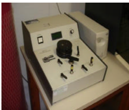
Figura 4.35 – Representação fotográfica do aparelho Picnômetro a gás utilizado para análise de densidade real.
