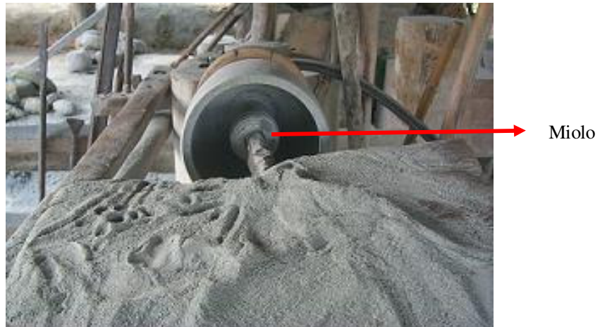
Figura 24 - Panela torneada e lixada, antes de ser retirada do torno.
