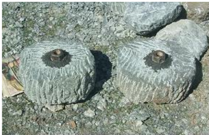
Figura 21: Peça furada com o pino
