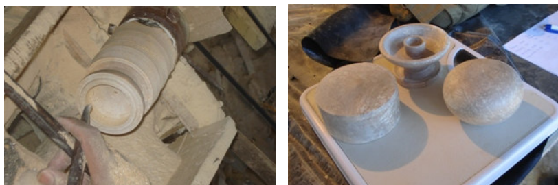
(a) Processo de torneamento (b) Produtos finais obtidos
