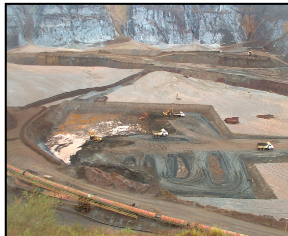
Figura 4.17 –Cava da Mina do Germano, atualmente utilizada como área de disposição de rejeitos do processo de beneficiamento de minério da Mina de Alegria (Mariana, MG).
