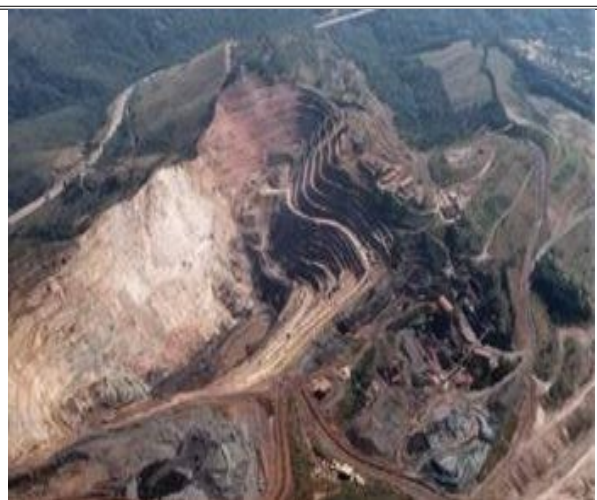
Figura 4.19 –Cava da Mina da Mutuca, que será utilizada para disposição do rejeito proveniente da Mina Capão Xavier.
