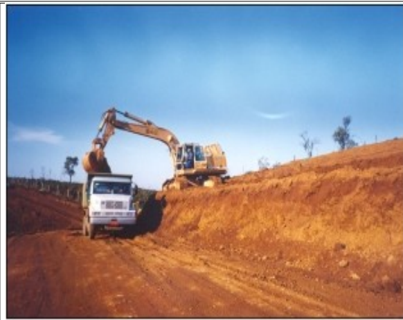
Figura 4.12 – Faixa do terreno da Mina de Itamarati, sendo aberta para extração de bauxita.
