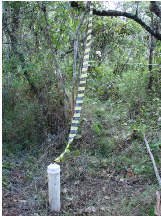
Figura 1.7.2 – Piezômetro instalado no interior dos fragmentos de floresta paludosa estudados no Parque Estadual do Itacolomi (PEIT), Ouro Preto, MG.
