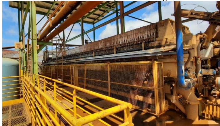
Figura 23 - Filtro prensa diafragma
