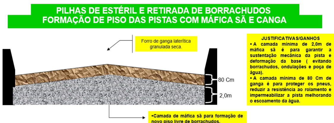
Figura 60: Acesso construído em depósitos de estéril com base em rocha sã.
