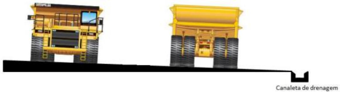
Figura 11: Inclinação transversal com caimento lateral único.
