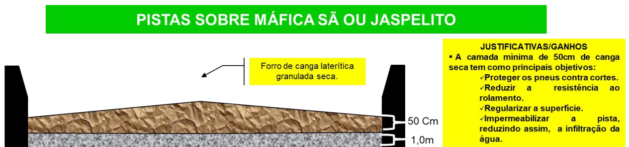
Figura 62: Acesso construído sobre rocha máfica sã com revestimento laterítico.
