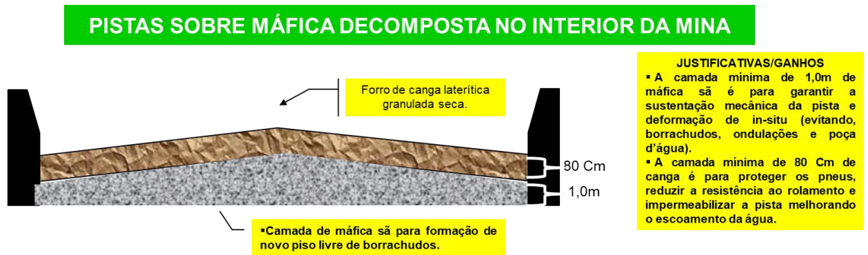
Figura 61: Acesso construído em pistas no interior da mina com base em rocha sã.
