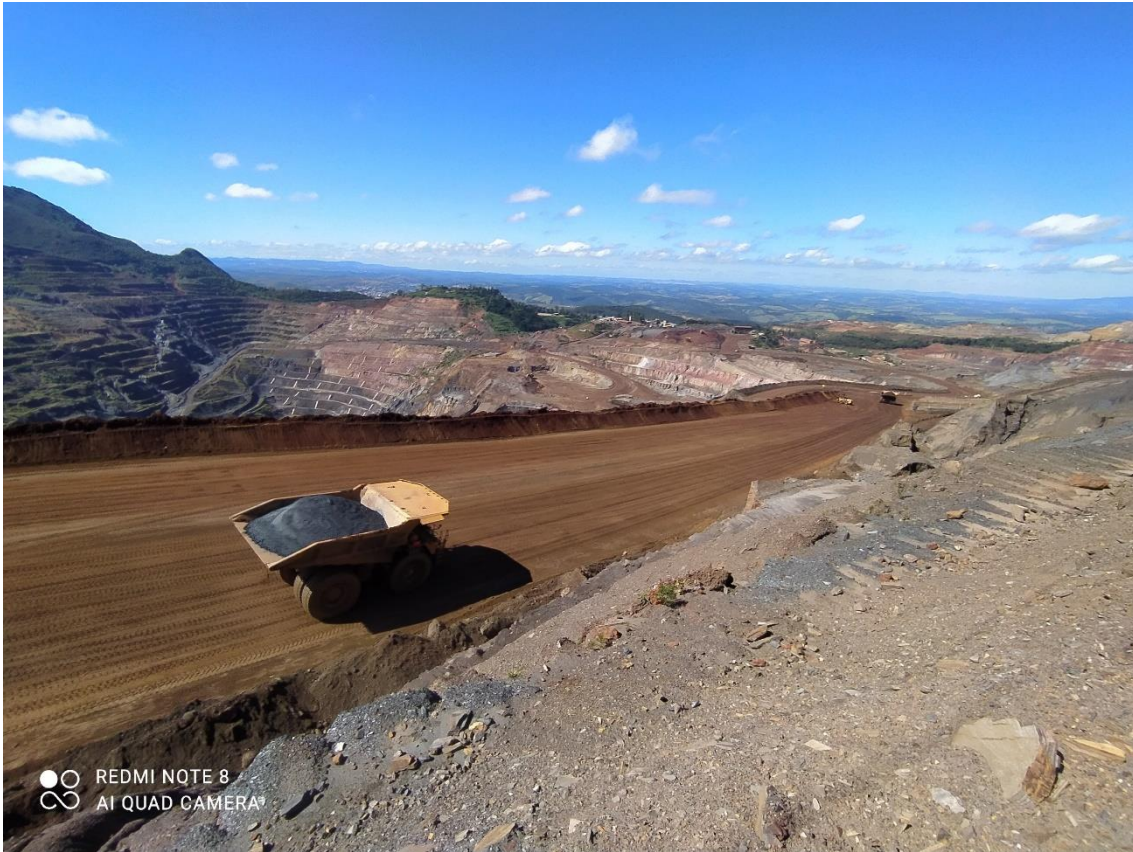
Figura 80: Acesso 10H adequado e conformado com itabirito fino.
