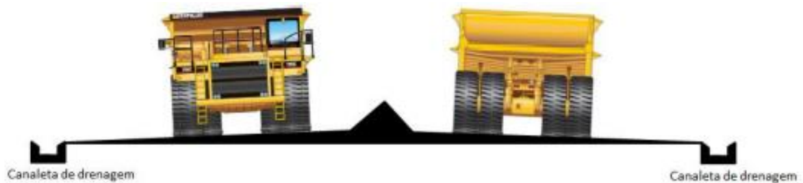
Figura 12: Inclinação transversal com abaulamento central.
