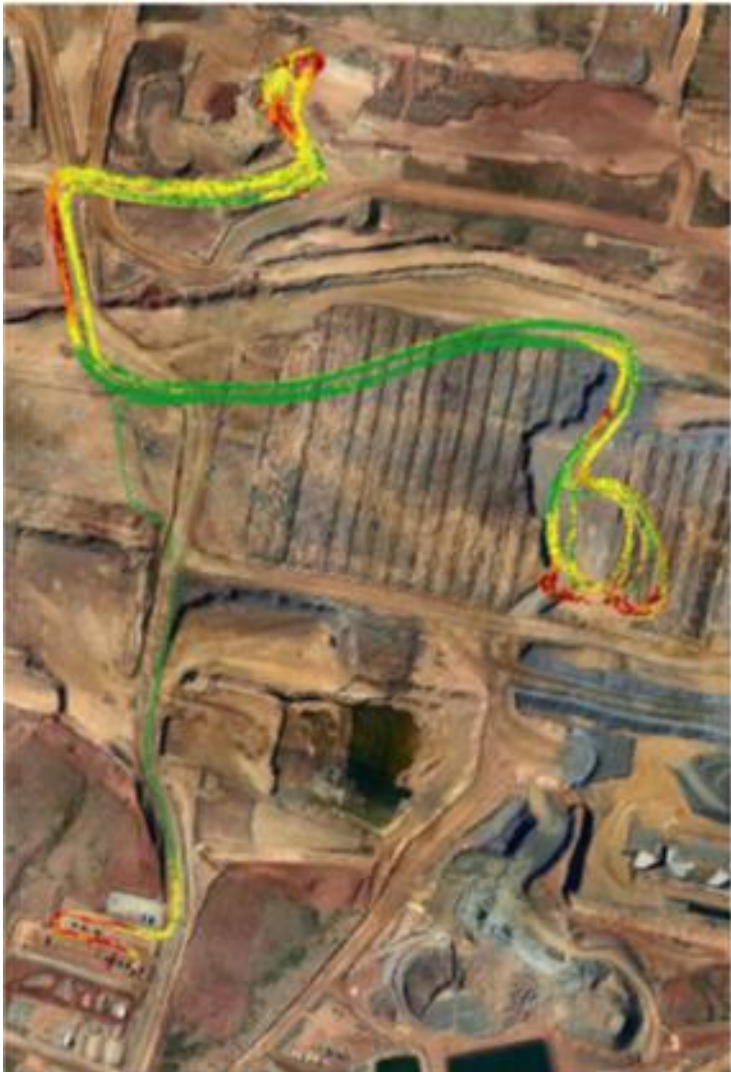
Figura 35: Uma operação de veículo em dados de rugosidade de uma estrada no local da mina. Inicialmente, o veículo está saindo de um estacionamento de caminhões, em seguida, deslocando o material e retornando ao estacionamento de caminhões.
