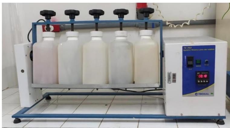
**Figura 32 - Agitador rotativo para não voláteis utilizado no ensaio de lixiviação. (Fonte: autora)**
