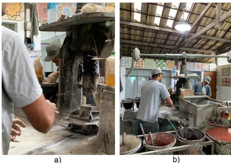
**Figura 18 - Etapa 10 – Levar à prensa: a) fôrma posicionada na prensa; b) ladrilheiros utilizando prensa manual. (Fonte: autora)**
