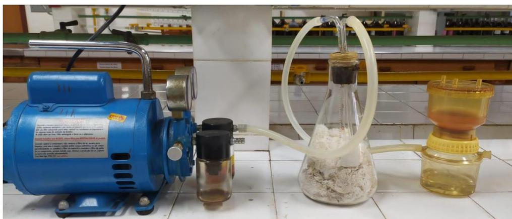
**Figura 33 - Sistema de filtragem da amostra. (Fonte: autora)**
