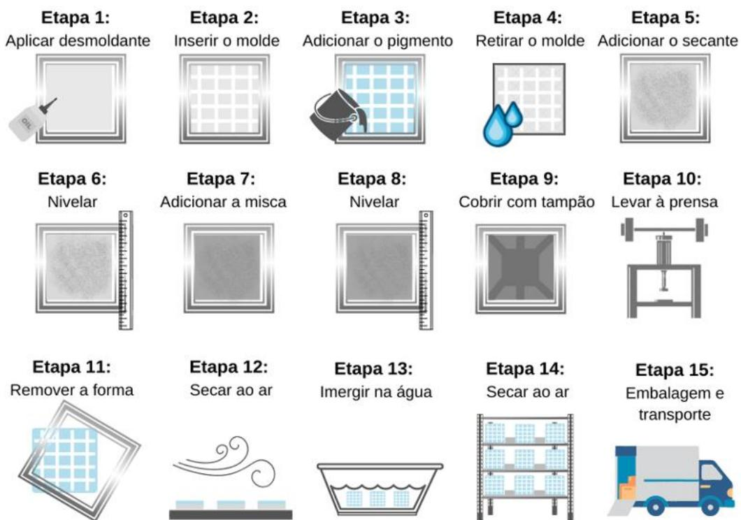
Figura 10 - Passo a passo para a fabricação de ladrilhos hidráulicos. (Fonte: autora)
