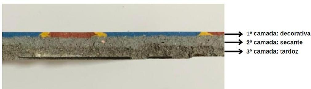
**Figura 9 - Corte em ladrilho hidráulico para visualização das camadas. (Fonte: autora)**
