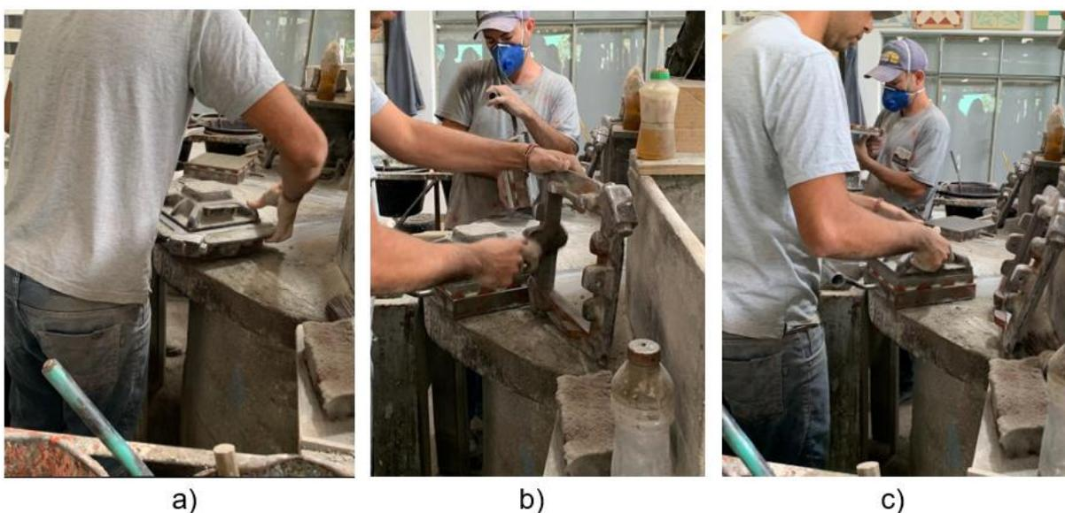
**Figura 19 – Etapa 11 – Remover da forma: a) retirada do esquadro de ferro; b) limpeza do esquadro; c) retirada do tampão de ferro. (Fonte: autora)**
