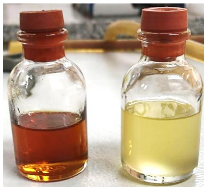
Figura 26 – Fases do efluente gerado após a etapa de modificação química
