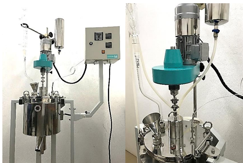
Figura 23 – Reator de aço inoxidável 304 utilizado no aumento de escala do bioadsorvente
