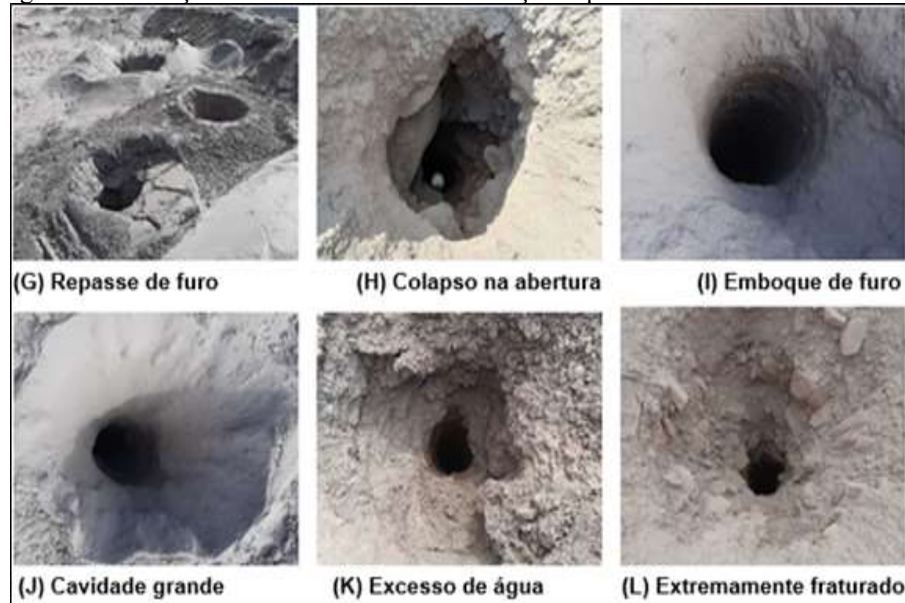
Figura 35: Condições estruturais da rocha e situações operacionais dos furos banco 850
