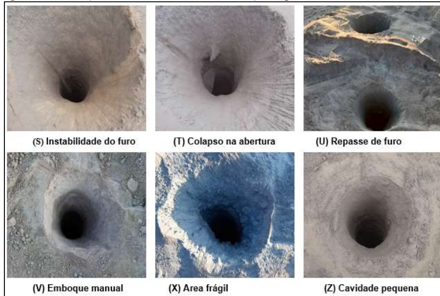
Figura 37: Condições estruturais da rocha e situações operacionais dos furos banco 950
