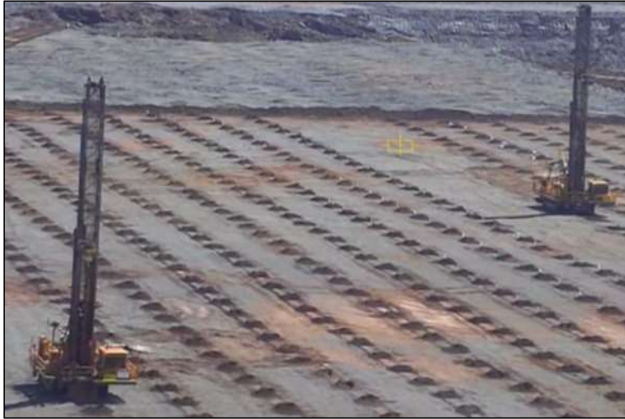
Figura 32: Perfuração com o auxílio do sistema GPS
