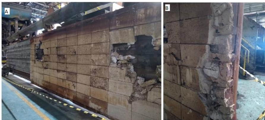
Figura 5.19. Porta seca: A) Vista da metade da porta já desmontada; B) Imagem da lateral da porta.
