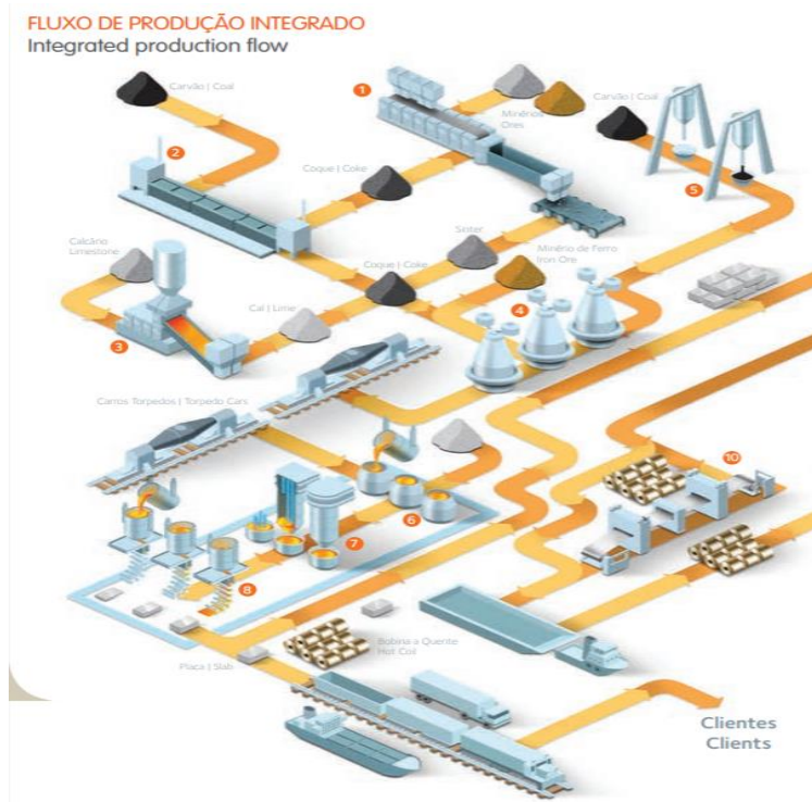
Figura 3.4. Fluxograma de processos da ArcelorMittal Tubarão (Fonte: Catálogo de produtos laminados – Edição 2015 – ArcelorMittal Aços Planos América Latina – Brasil).
