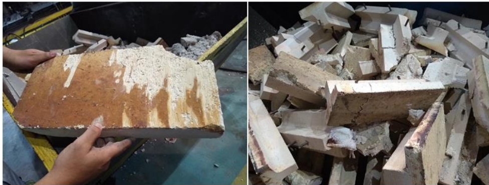
Figura 5.18. Blocos danificados que foram retirados da porta seca.
