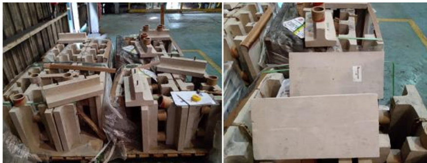
Figura 4.3. Blocos refratários prontos para inspeção
