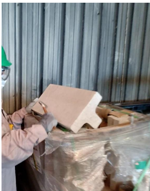
Figura 5.24. Teste de percussão nos blocos da porta seca
