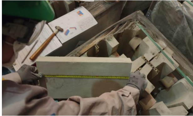
Figura 5.21. Inspeção dimensional nos blocos da porta seca.
