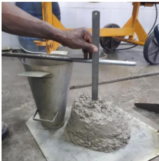
Figura 5 - Ensaio de Abatimento de Tronco de Cone. Fonte: Borges (2019)
