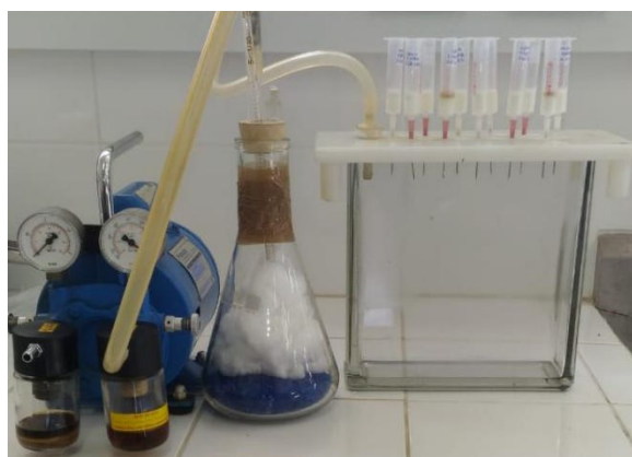
Figura 6 - Sistema empregado para a secagem dos cartuchos utilizados na extração
