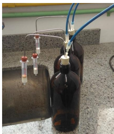
Figura 5 - Sistema empregado para realizar a extração dos compostos presentes nas amostras
