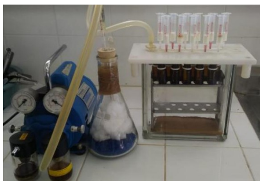
Figura 8 - Secagem com gás nitrogênio do solvente utilizado para eluição
