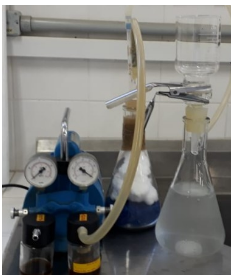
Figura 4 - Sistema utilizado para filtração das amostras afim de remover sólidos suspensos
