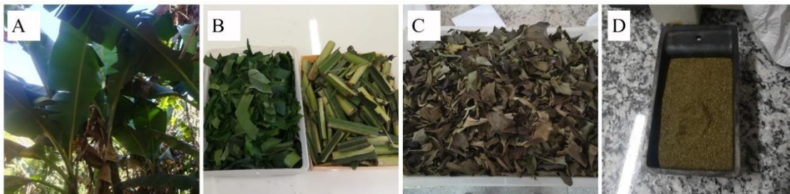
Figura 6. Processo de produção de biomassa de folha de bananeira - A) precursor: pés de banana caturra. B e C) Separação e secagem. D) Biomassa moída para pirólise.
