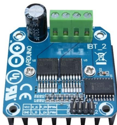
Figura 15: Ponte H BTS7960.
