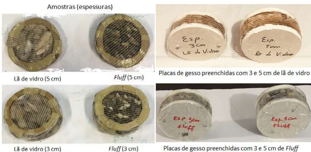
Figura 20 - Amostras preparadas para medições no tubo de impedância
