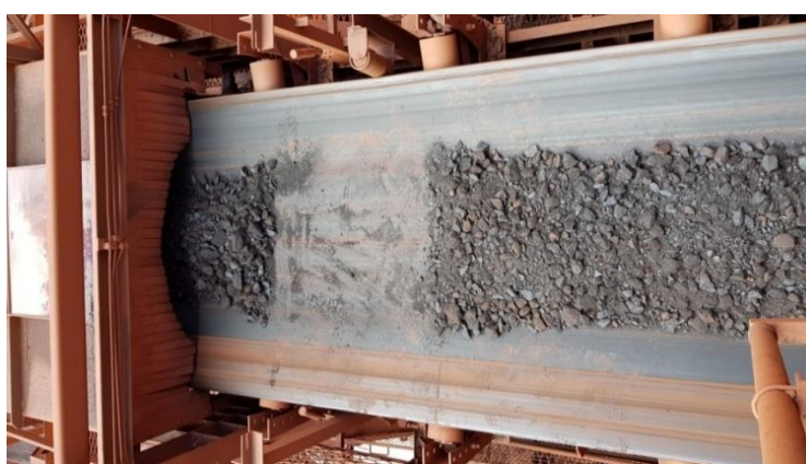
Figura 3.3: Distribuição granulométrica de saída do produto para APF de 41 mm. Fonte: MOREIRA e EUZÉBIO, 2018.
