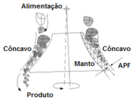
Figura 1.3: Princípio de um britador cônico. Fonte: HULTHÉN, 2010.
