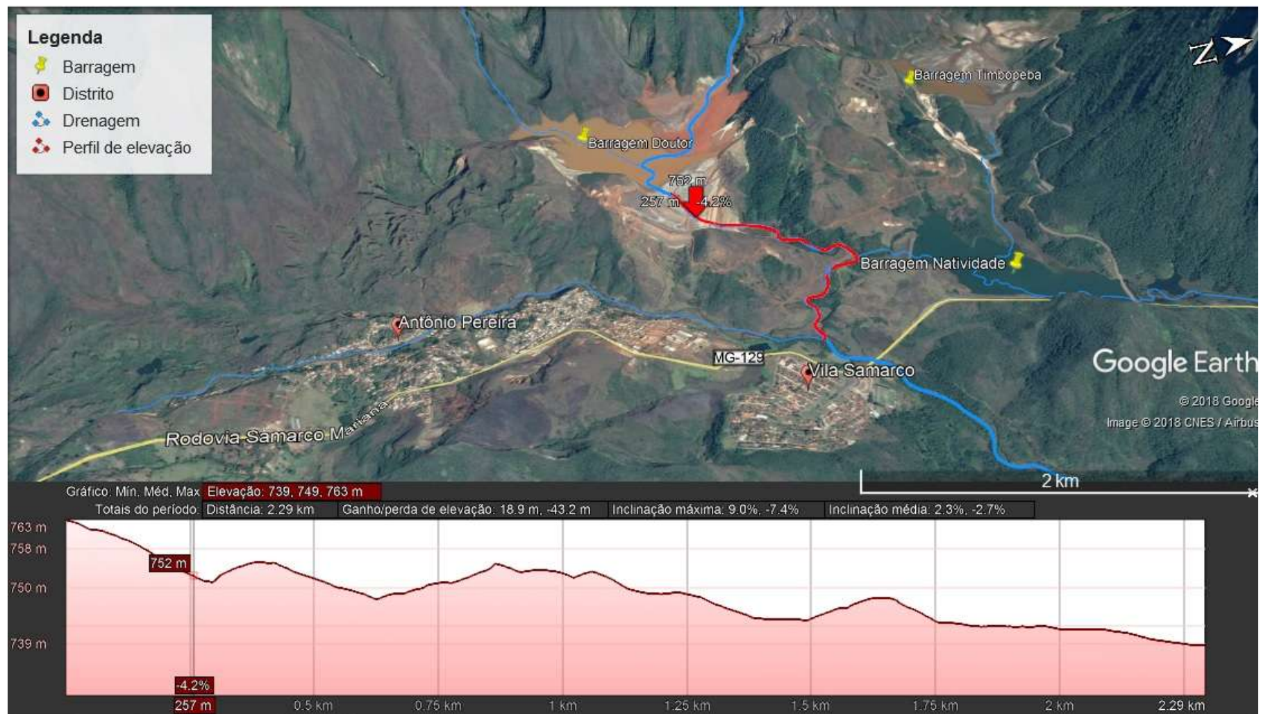
Figura 6.9 - Provável fluxo de lama conforme drenagem da região e o perfil de elevação (ponto mais alto do talude e a ocupação urbana mais próxima), em caso de ruptura da barragem Doutor.
