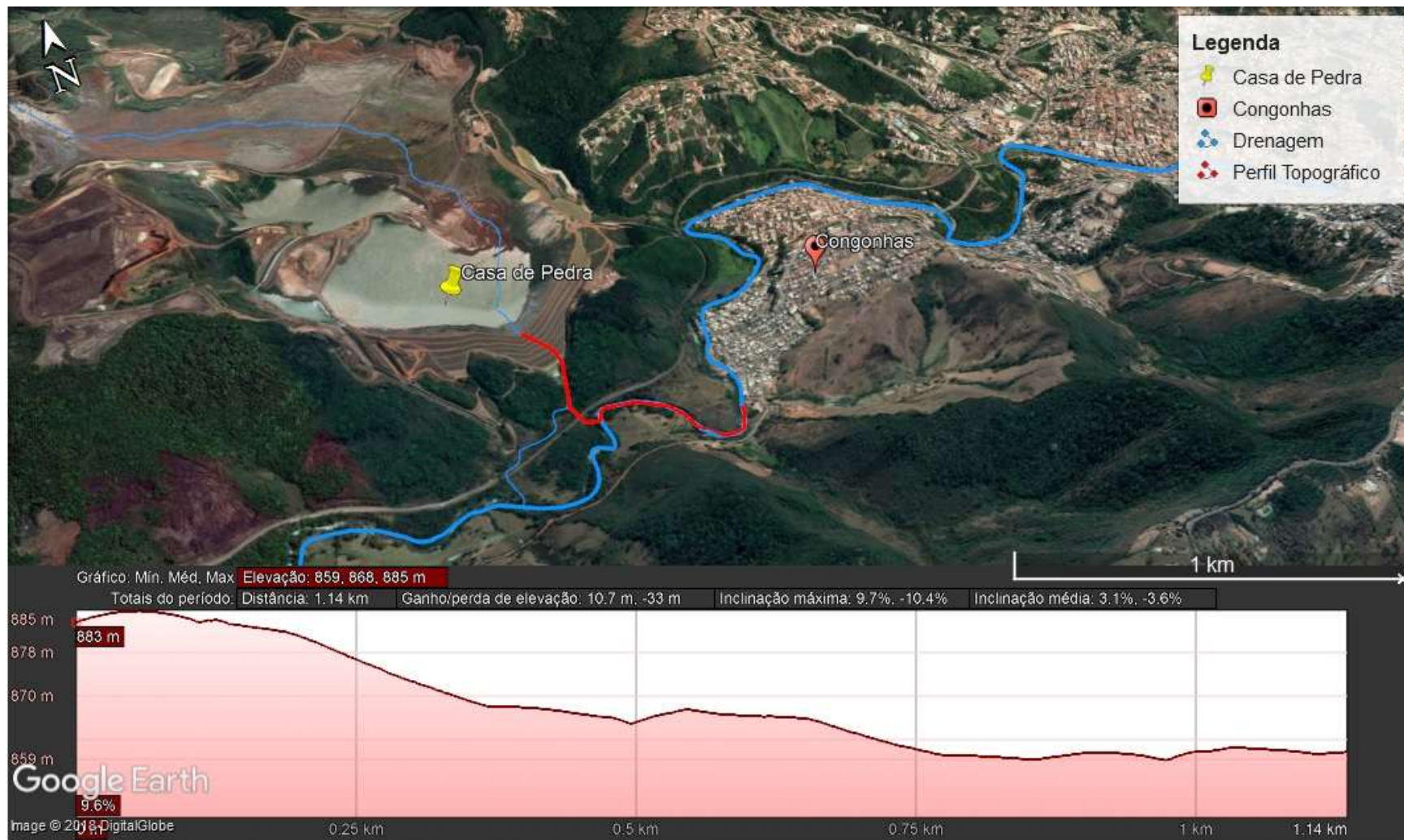
Figura 6.15 - Provável fluxo de lama conforme drenagem da região e o perfil de elevação (ponto mais alto do talude e a ocupação urbana mais próxima), em caso de ruptura da barragem Casa de Pedra.
