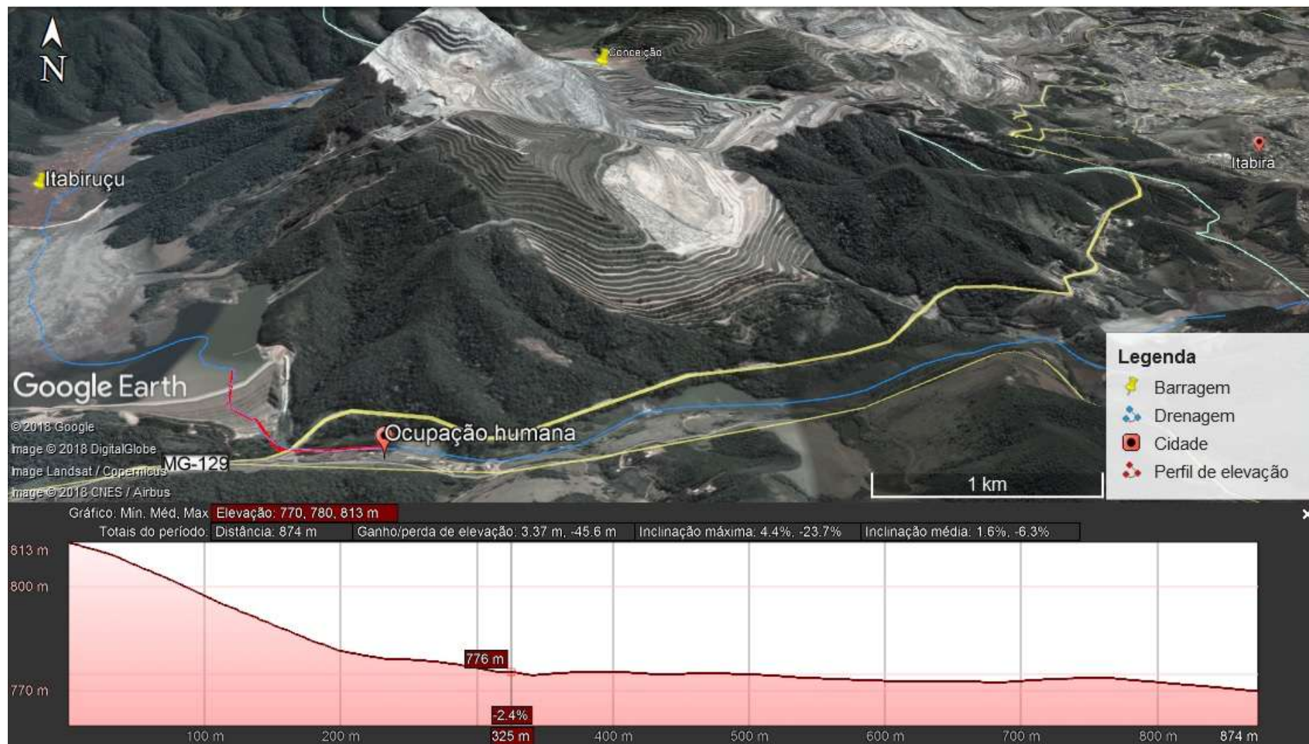
Figura 6.5 - Provável fluxo de lama conforme drenagem da região e o perfil de elevação (ponto mais alto do talude e a ocupação urbana mais próxima), em caso de ruptura da barragem Itabiruçu.
