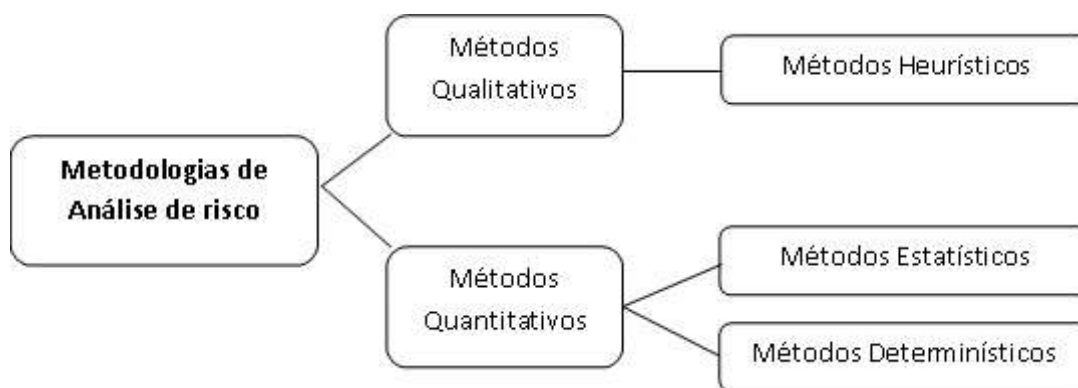
Figura 3.10 - Metodologias para análise de risco em barragens. Adaptado de Aleotti e Chowdhuty (1999) e Soeters e van Western (1996).
