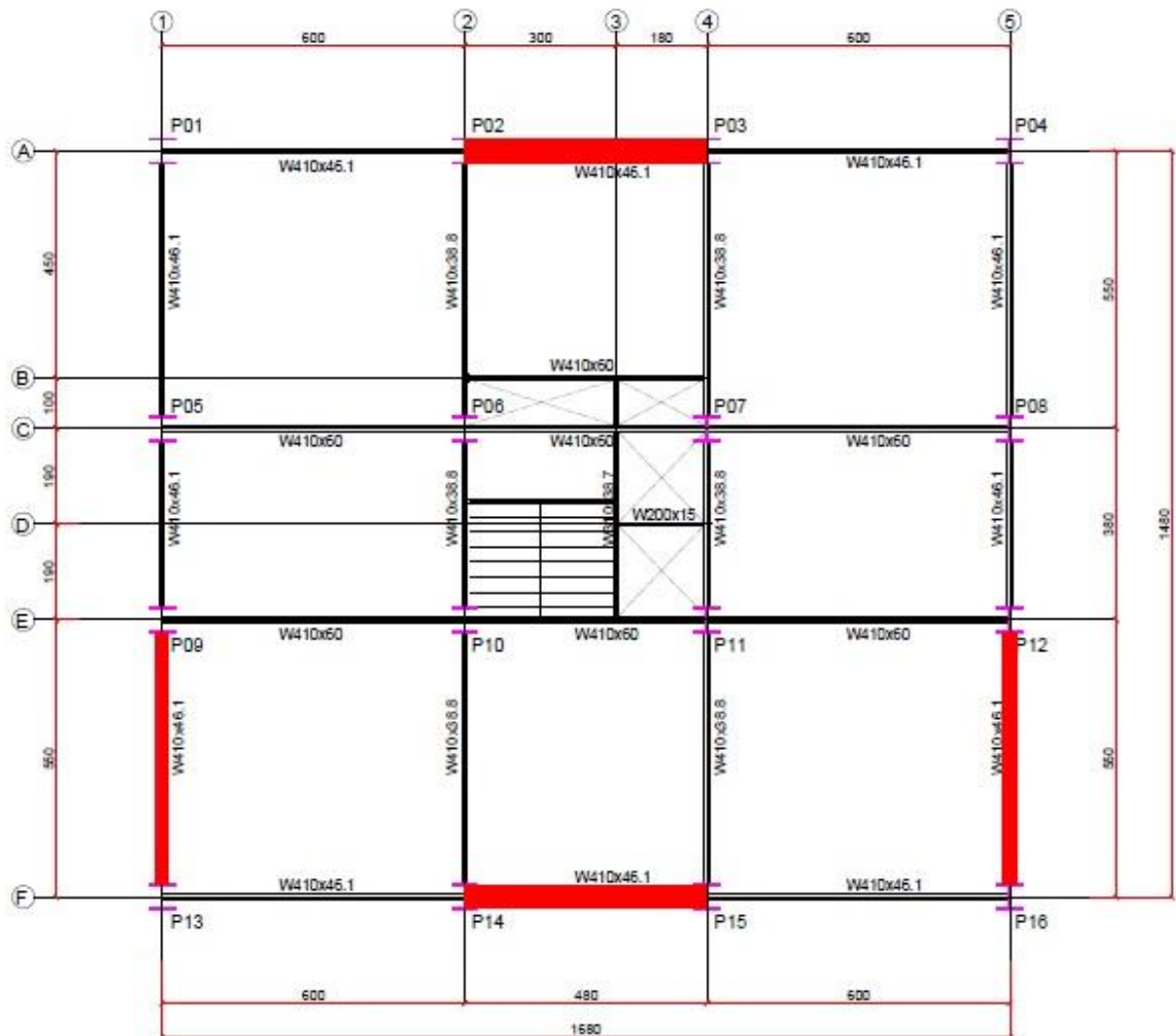
Figura 3.9: Planta de localização das quatro treliças verticais de contraventamento
