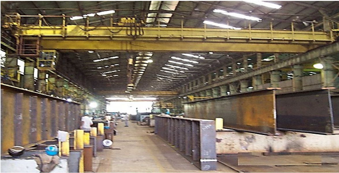
Figura 28 - Linha de acabamento de fabricação de perfis soldados
